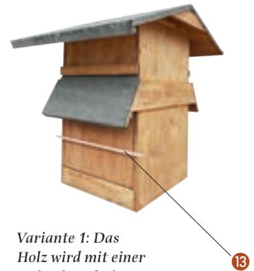
Variante 1: Das Holz wird mit einer Holzschutzfarbe gestrichen und die Dachpappe wird vernagelt.
